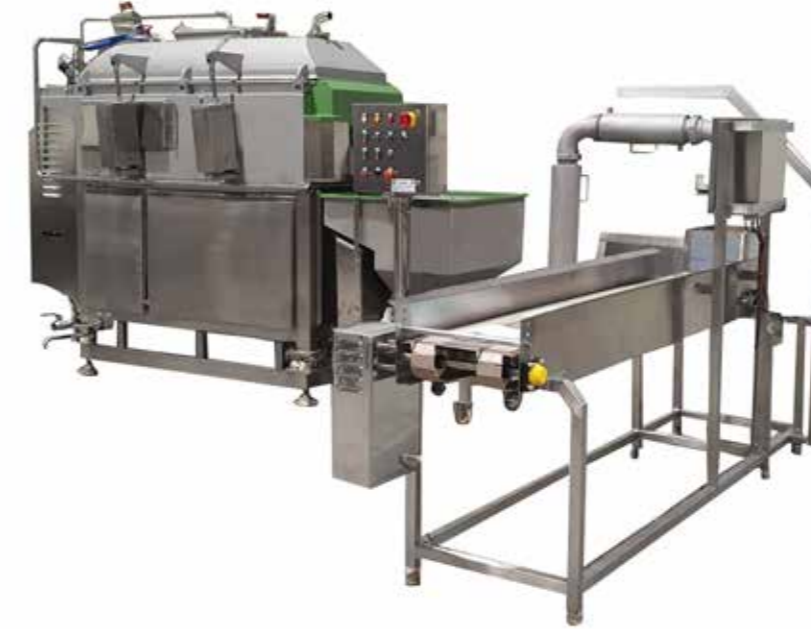
Continuous stretching line for mozzarella or analogue Linea filatura continua vapore ed acqua
